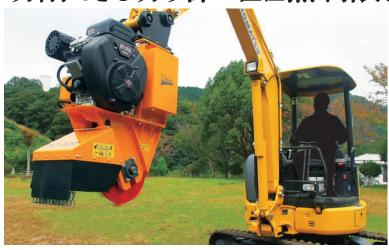
油圧ショベルに取り付ける、切り株カッターが登場! 機体に33馬力のエンジンを搭載しているため スピーディに切り株を粉砕します。刃の操作は、付属 のリモコンで始動・停止ができます。
