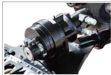
遊星歯車減速機装着で力強く切断 L型はモーター直結式
