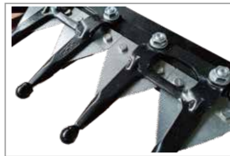
刃物の脱着が容易 (ボルト固定)
